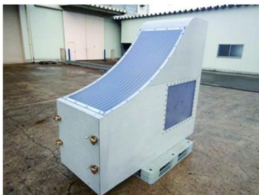
無動力除塵取水器(実機)
